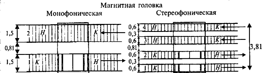
Рис. 68. Дорожки кассетных магнитофонов
