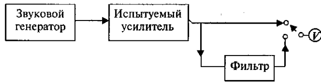
Рис. 13. Схема для определения коэффициента гармоник
